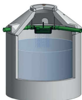
Zu- und Ablaufhöhe 620 mm unterhalb der Schachtabdeckung.
